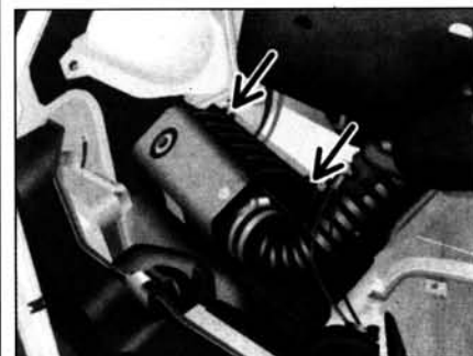
Рис. 1.88. Снятие крышки воздушного фильтра.
